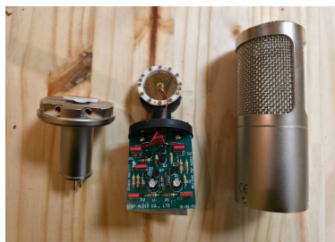
Microphone remplacement des condensateurs
