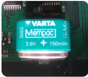
Pile mémoire HS avec oxydation
